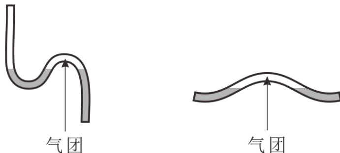
图 4 错误的管道连接图示
